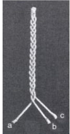
Fig. 8-91 – Gaxeta simples, de três cordões
