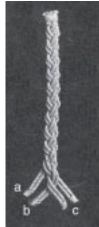
Fig. 8-98 – Gaxeta simples, de três cordões dobrados
