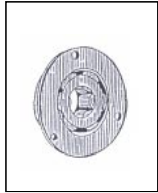
Fig. 9-14 – Roldana de bucha com redutor de atrito
