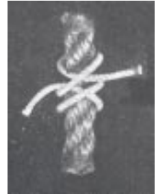
Fig. 8-7 – Volta de fiel dobrada
