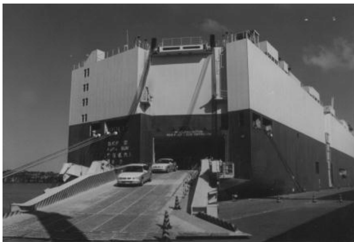
Fig. 3-35 – Navios de carga modular rolante (Ro/Ro)
