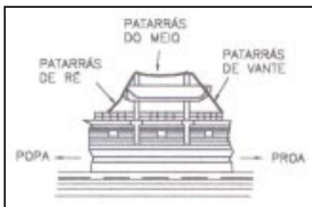
Fig. 4-16 – Embarcação miúda no turco
