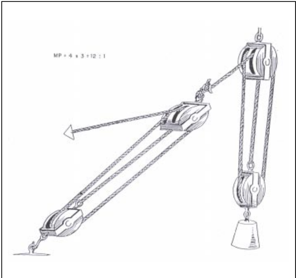
Fig. 9-23 – Aparelhos de laborar conjugados
