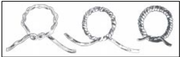
Fig. 8-163 – Estropo de anel, cabo de fibra
