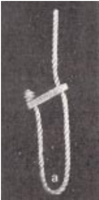
Fig. 8-122 – Modo de regular a tensão num cabo.
