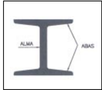
Fig. 5-2b – Alma e abas de um perfil "I"
