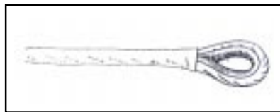
Fig. 9-30 – Mão com sapatilho em cabo de aço
