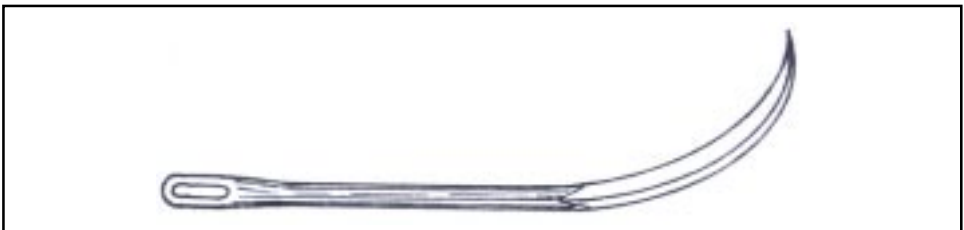
Fig. 8-157c – Agulha de palombar
