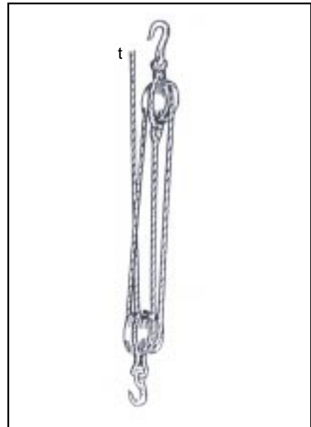
Fig. 9-18 – Talha singela (tirador saindo do cadernal móvel)
