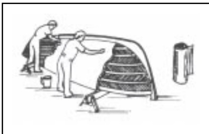
Fig. 15-17 – Colocação e impregnação do reforço de fibra de vidro
