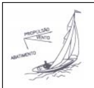
Fig. 5-26 – Esforços sobre as velas
