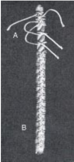
Fig. 8-81a – Embotijo em leque, de dois cordões
