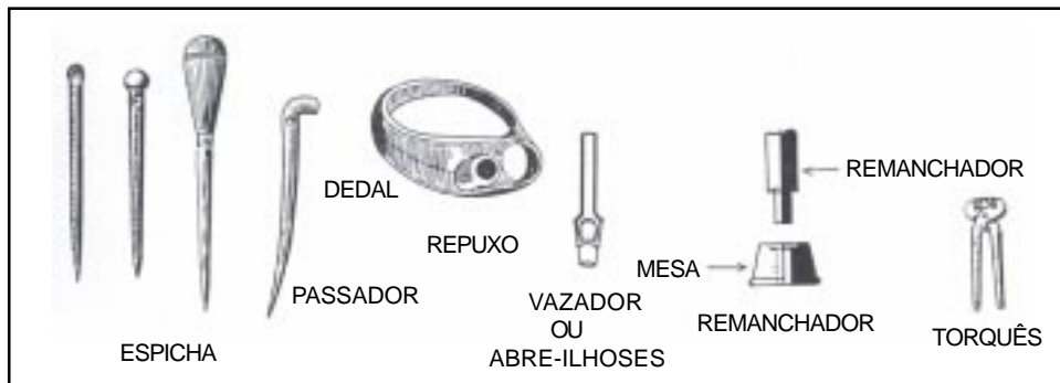
Fig. 8-154 – Espicha, Passador, Vazador, Remanchador e Torquês
