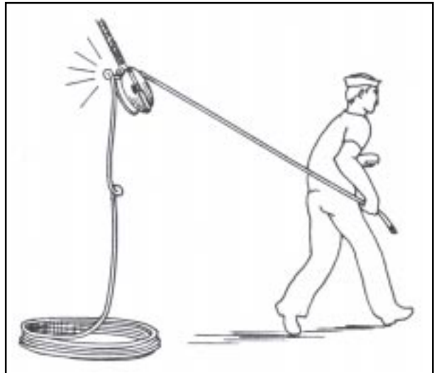
Fig. 7-15 – Resultado de colher um cabo com voltas para a esquerda
